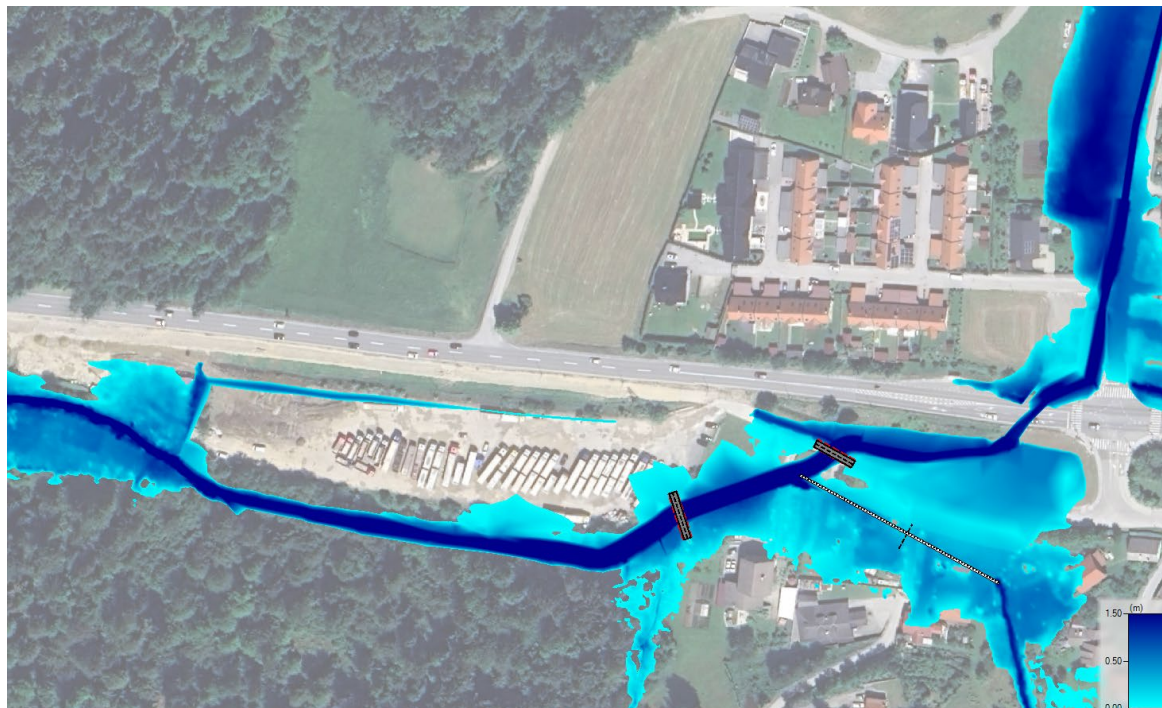
Slika 21: Rezultati za pretoke Q500 Trebušnice za načrtovano stanje.
