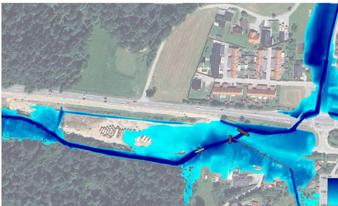
Slika 17: Rezultati za pretoke Q500 Trebušnice za obstoječe stanje.
