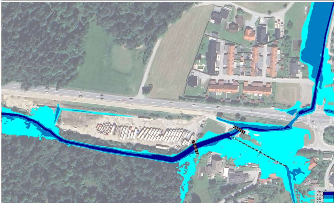
Slika 19: Rezultati za pretoke Q100 Trebušnice za načrtovano stanje.
