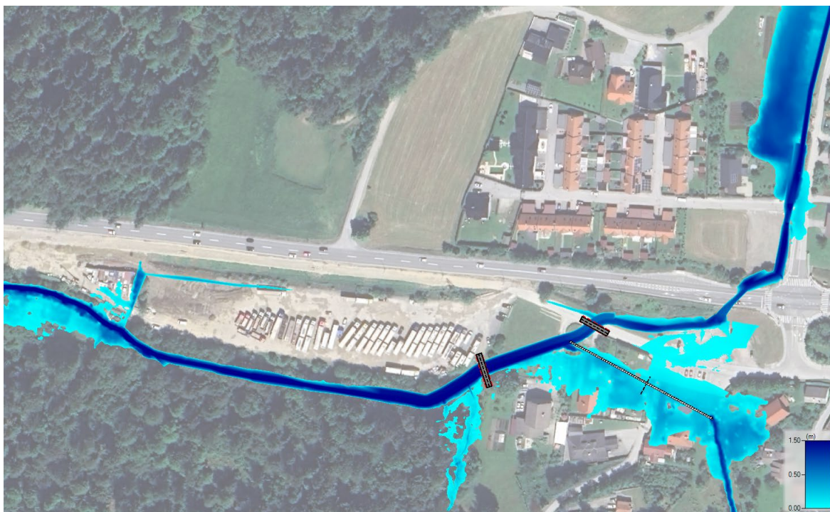
Slika 18: Rezultati za pretoke Q10 Trebušnice za načrtovano stanje.
