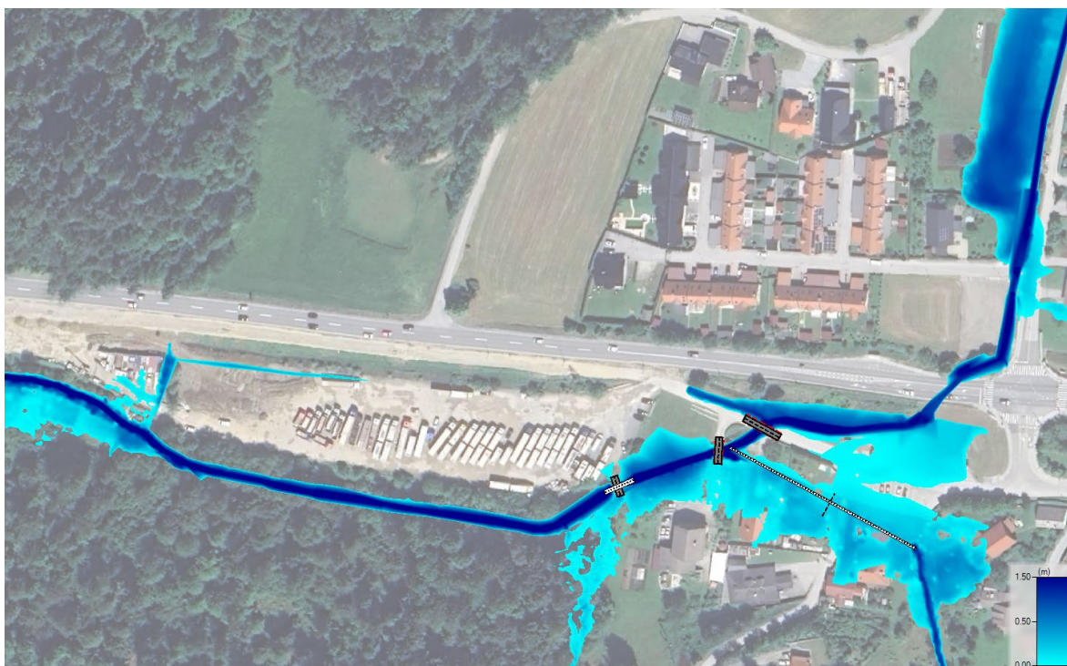
Slika 15: Rezultati za pretoke Q10 Trebušnice za obstoječe stanje.
