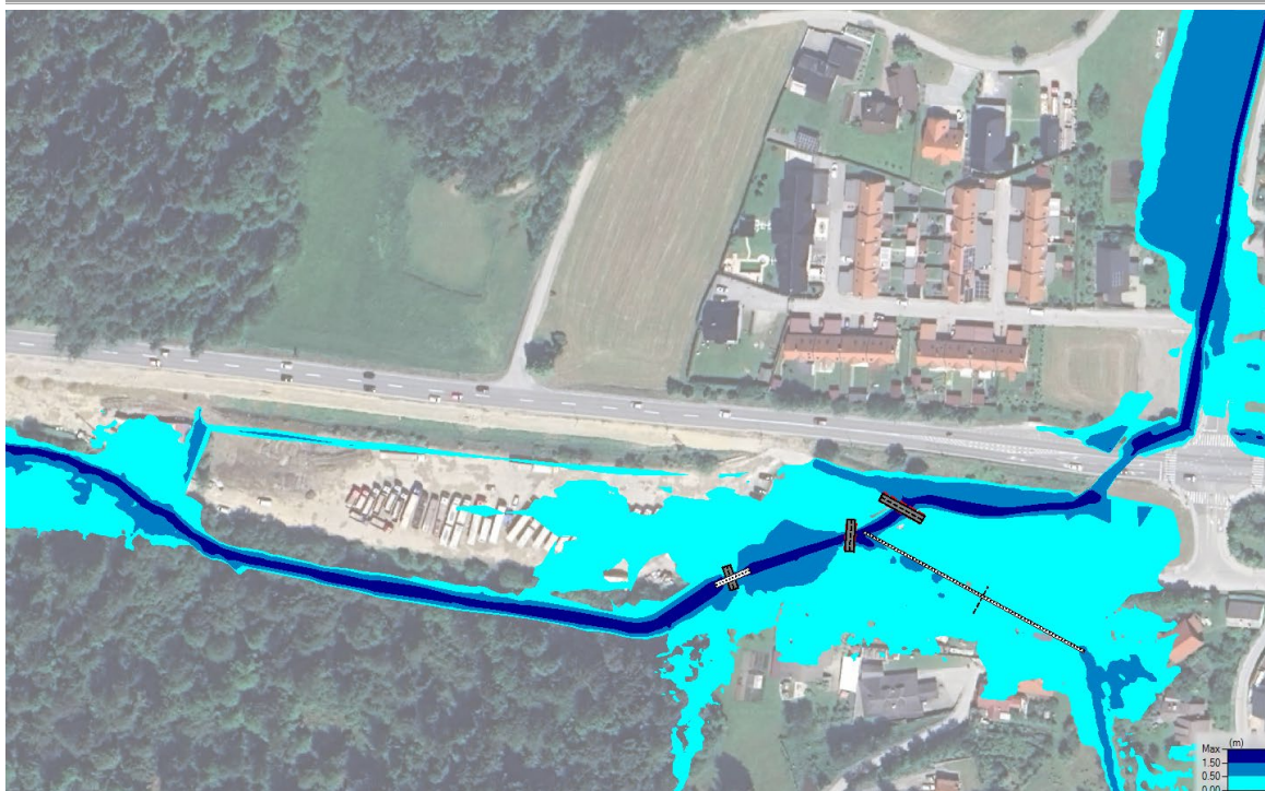
Slika 16: Rezultati za pretoke Q100 Trebušnice za obstoječe stanje.
